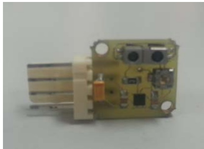
Figura 32: Sensor infrarrojo con circuito acondicionador
