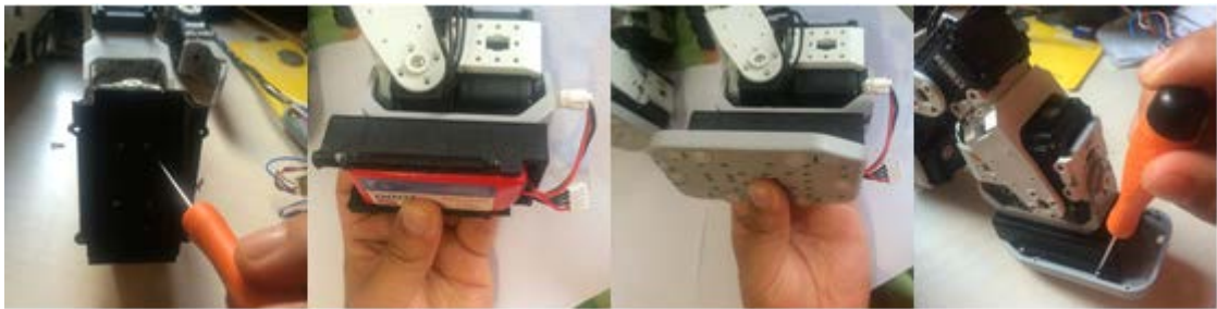
Figura 40 Montaje del soporte de las baterías
