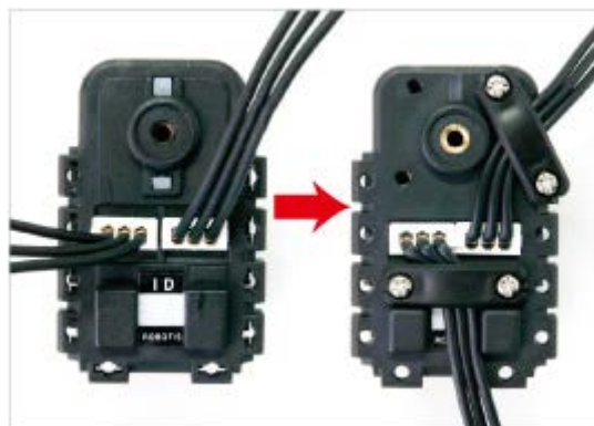
Figura 20: Servo Dynamixel con conexión TTL de 3 pines
