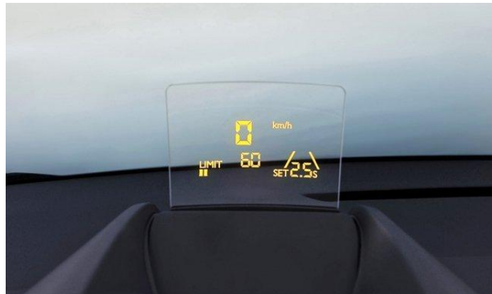
Ilustración 43 Sistema HUD Panel
