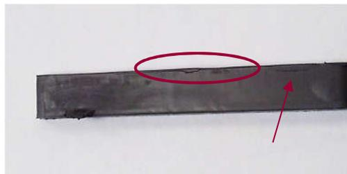
Figura 4.5. Fotografía de una de las piezas en verde inyectadas a baja presión, en la que se observan defectos en los bordes tras la extracción del molde
