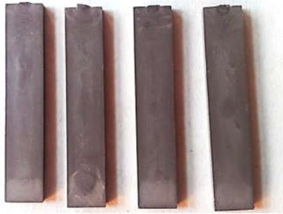
Figura 4.6. Imágenes de las piezas en verde inyectadas a alta presión
