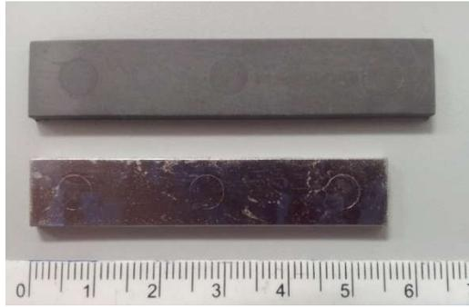
Figura 6.4. Comparación entre una pieza en verde (arriba) y una pieza sinterizada en vacío (abajo), de la aleación Fe-3.8Si
