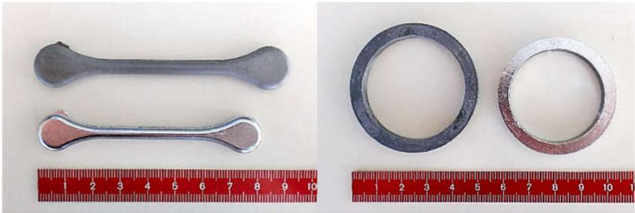
Figura 7.8. Piezas en verde comparadas con piezas sinterizadas. A la izda., probetas de tracción; a la dcha., toroides
