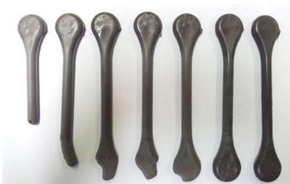
Figura 5.10. Piezas en verde obtenidas durante la optimización del llenado del molde en el proceso de moldeo por inyección
