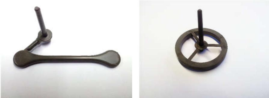
Figura 5.11. Piezas en verde obtenidas tras la optimización del proceso de moldeo por inyección. A la izda., pieza de tracción, y a la dcha., toroide
