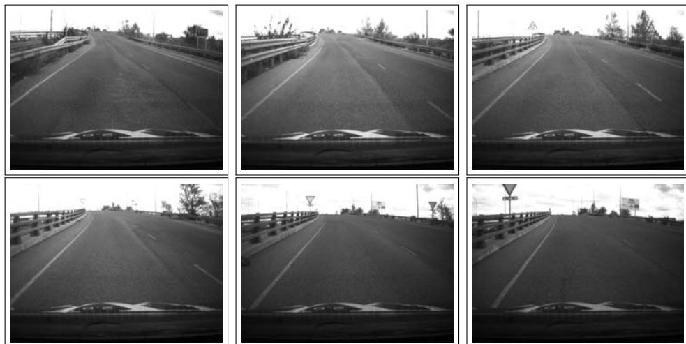
Figura 5.12: Secuencia de referencia 2 con líneas degradadas ó poco visibles para la detección de marcas viales.
