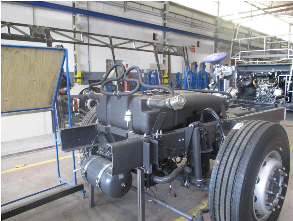
Figura 4. 3. Eje delantero de un autobús
