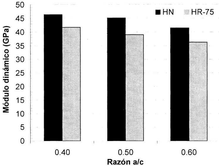
Figura 4. Relación entre la razón a/c y el módulo de elasticidad dinámico.
