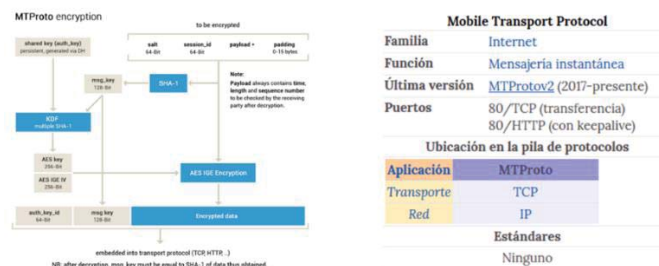
Fig. 2. Encriptación de mensajes Telegram mediante SHA-1. Ubicación del MTPProto en el stack de protocolos de comunicaciones
