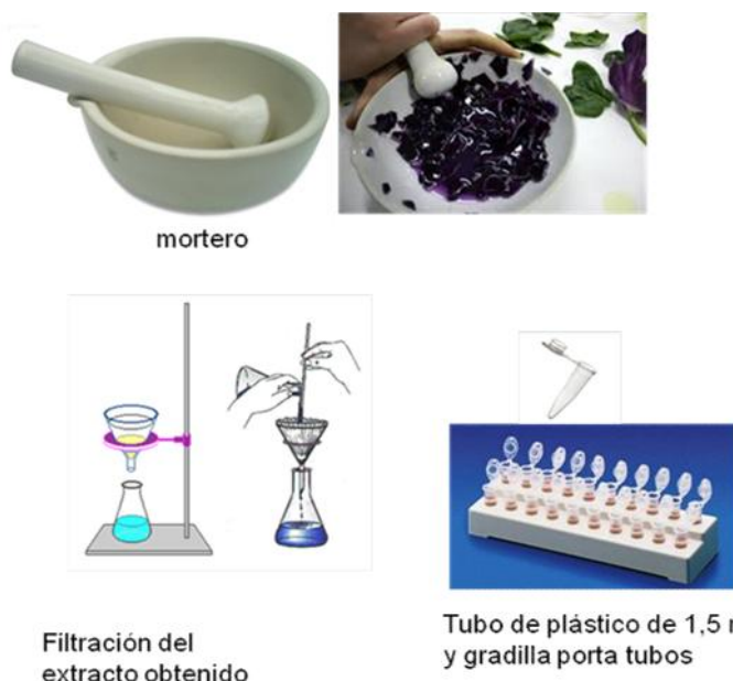
Figura 1- Materiales de laboratorio utilizados por los alumnos para extraer los pigmentos.
