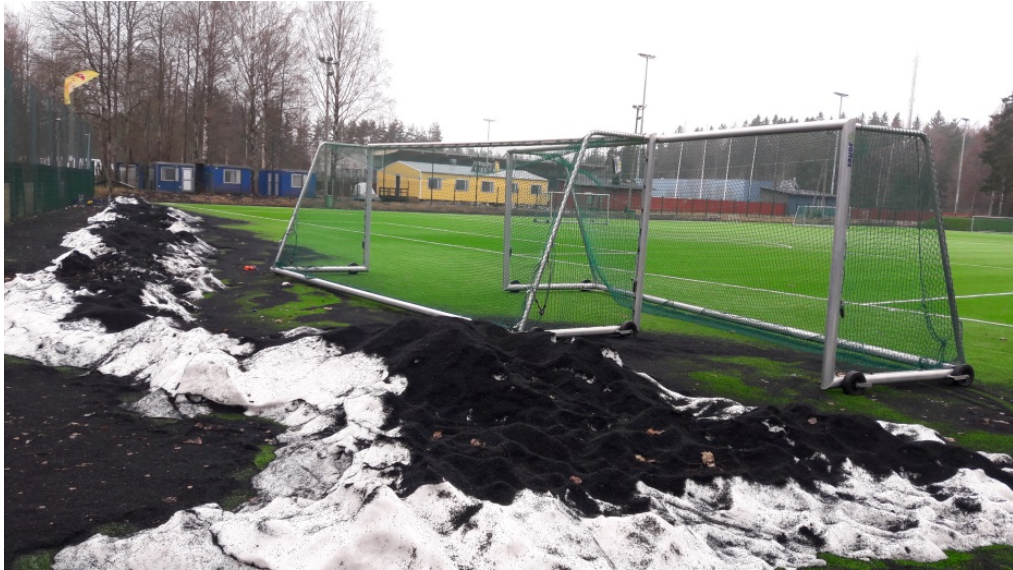
Kuva 17. SBR-kumirouhetta jalkapallokentän laidalla Helsingissä. Kuva: Outi Setälä.
