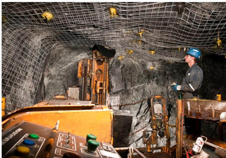
Figure 5.26: Vue de la boulonneuse à plateforme en opération (fournie par AEM)
