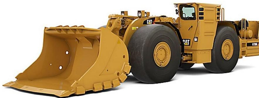
Figure 2.21: Chargeuse-navette typique (tirée de [Caterpillar Inc., 2011](#))
