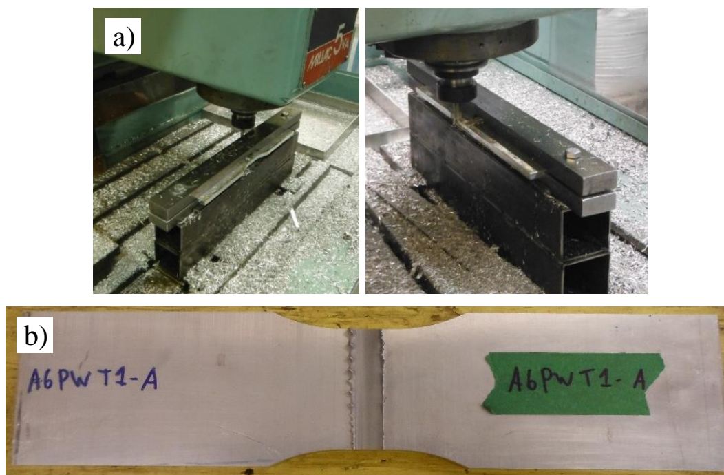
Figure 3.9 - Échantillon de fatigue a) Usinage b) Forme finale
