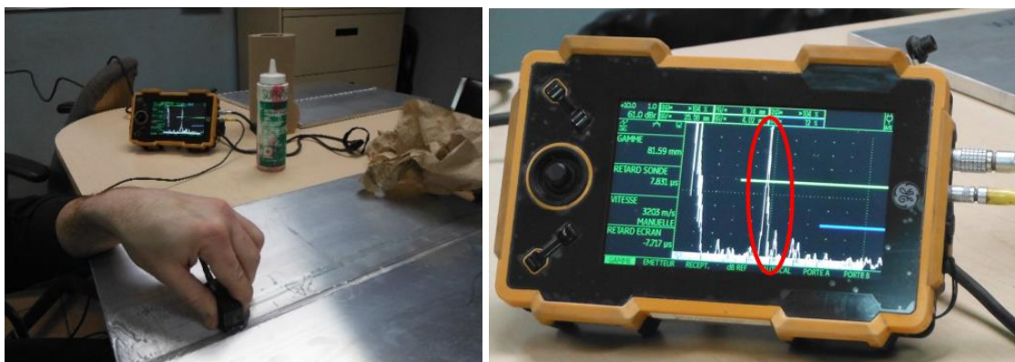
Figure 3.27 - Équipement d'inspection par UT
