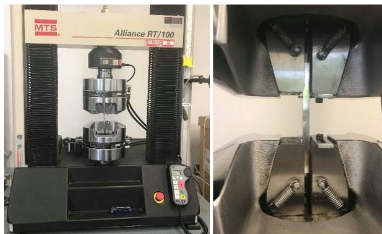
Figure 3.11 - Presse hydraulique pour les essais de traction
