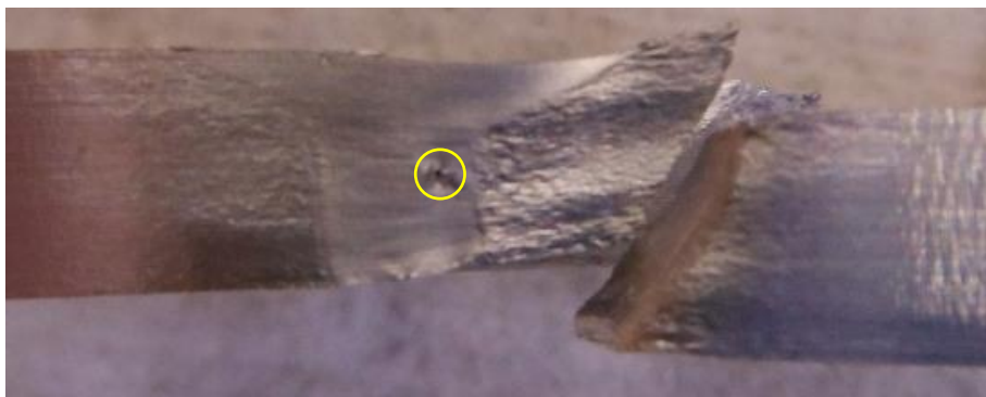
Figure 3.30 - Face élongée de l'échantillon de fatigue WH06-A à 30mm du début de la soudure
