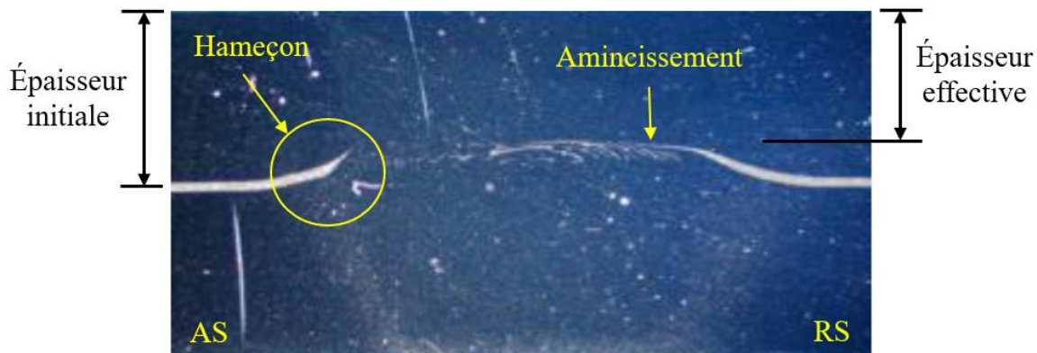
Figure 2.18 - Section transversale d'un joint en recouvrement d'un alliage 2024-T3 [44]
