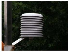
(d) Outdoor air temperature Figure 3. Monitoring devices
