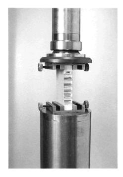
Figure 1.3.2. C364 Edge wise compressive testing
