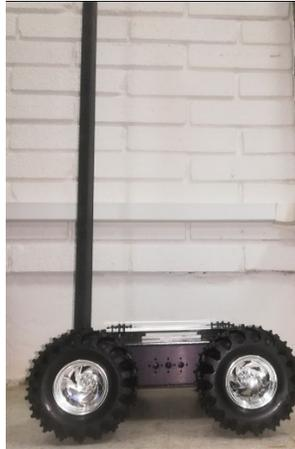
*Figura 49. Plataforma robótica móvil con mástil*
