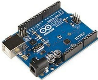
*Figura 51. Tarjeta de programación Arduino UNO*
