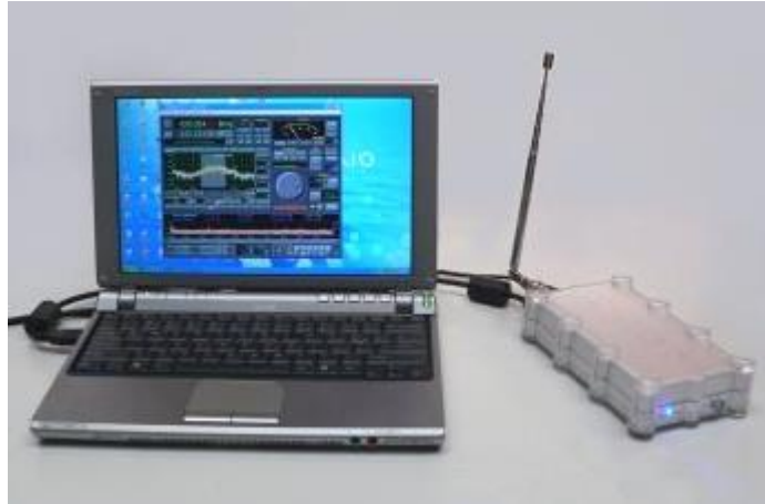
Figura 4.25. Estación terrena SDR (Radio definida por software) [193].
