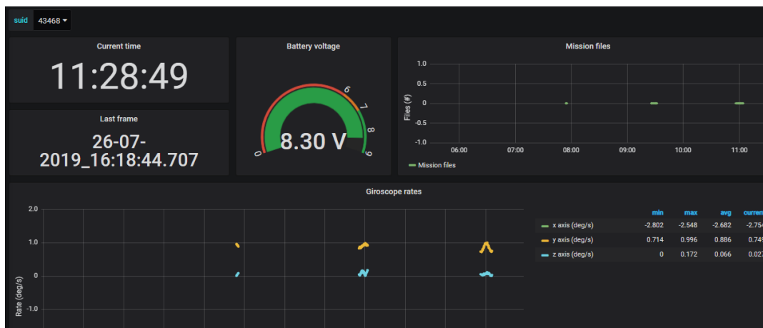
Figura 4.30. Plataforma visualizando datos del cubesat IRAZU conectado a la red satNOGS (Satellite Networked Open Ground Station) [91].
