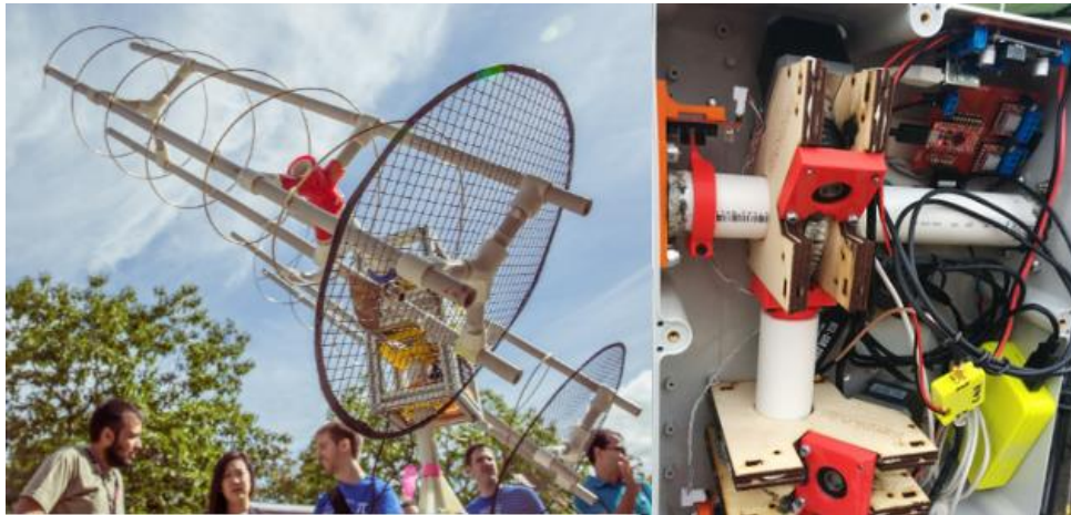
Figura 4.29. Antena, rotor y driver construida para una Base terrena [90].
