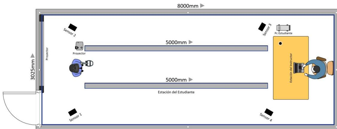
Ilustración 122 Distribución de estaciones y hardware de simulación
