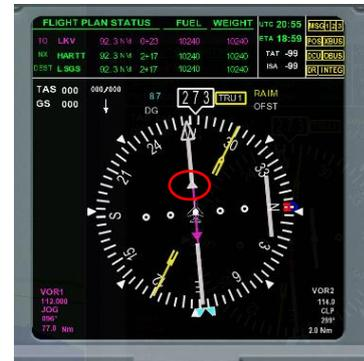
**Gambar 20.** HSI sebelum pesawat melewati CLP jarak 2 Nm
