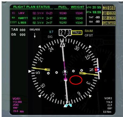
**Gambar 22.** HSI tepat pesawat melewati CLP jarak 0 Nm
