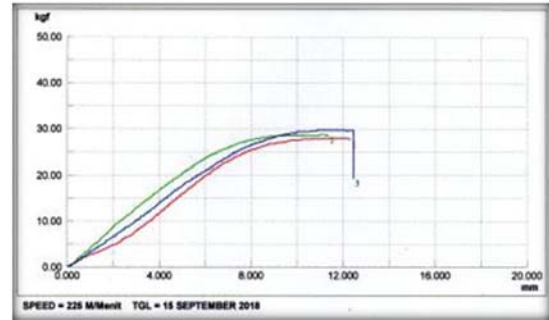
Gambar 5. Grafik hasil pengujian kuat tarik dan pemuluran setelah proses wet drawing dengan kecepatan 225 M/menit.
