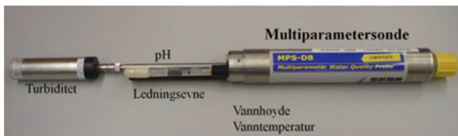
Figur 3. Multiparametersonde (MPS-D8) som er benyttet på stasjonene for kontinuerlige automatiske målinger.
