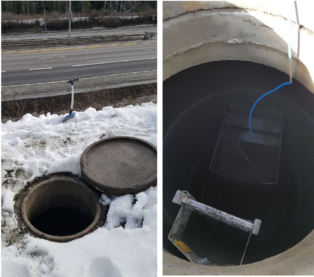
Figur 4. Plassering av multiparametersonde for automatisk overvåking av vannkvalitet ved Åsland snødeponi og E6
