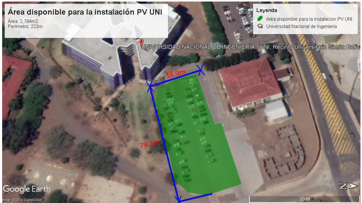
Ilustración 37 Área propuesta para el sistema PV Fuente: Google Earth
