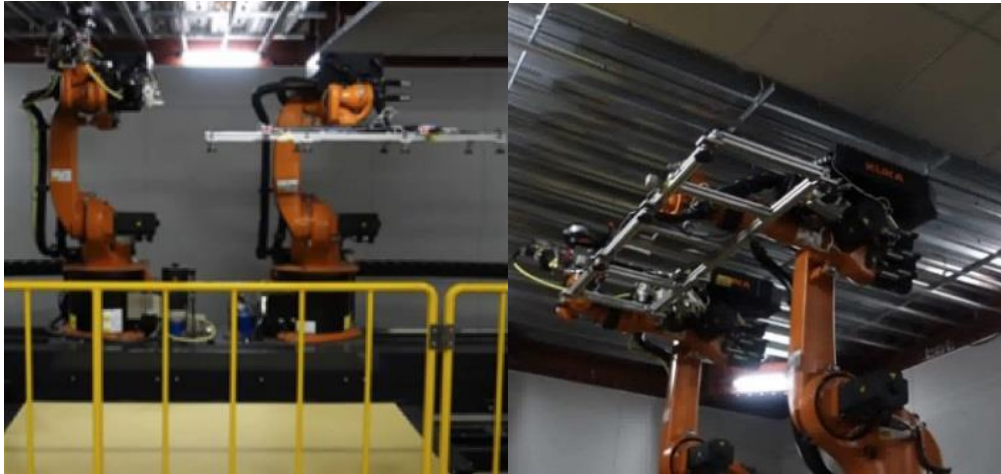
Kuva 16. Toinen robottikäsi tarttuu paneeliin ja toinen ruuvaa sen kiinni (Shimzu Corporation 2018)
