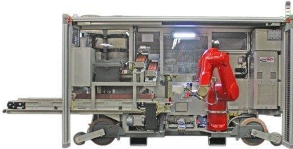
Kuva 7. Muurausrobotti SAM100 (Construction Robotics 2019)
