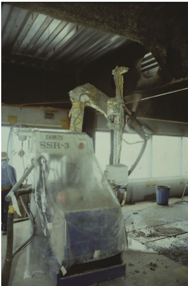
Kuva 13. Shimizu Corporationin kehittämä SSR-3 paloeristeen ruiskutusrobotti (Thomas & Thomas 2016, s. 240)
