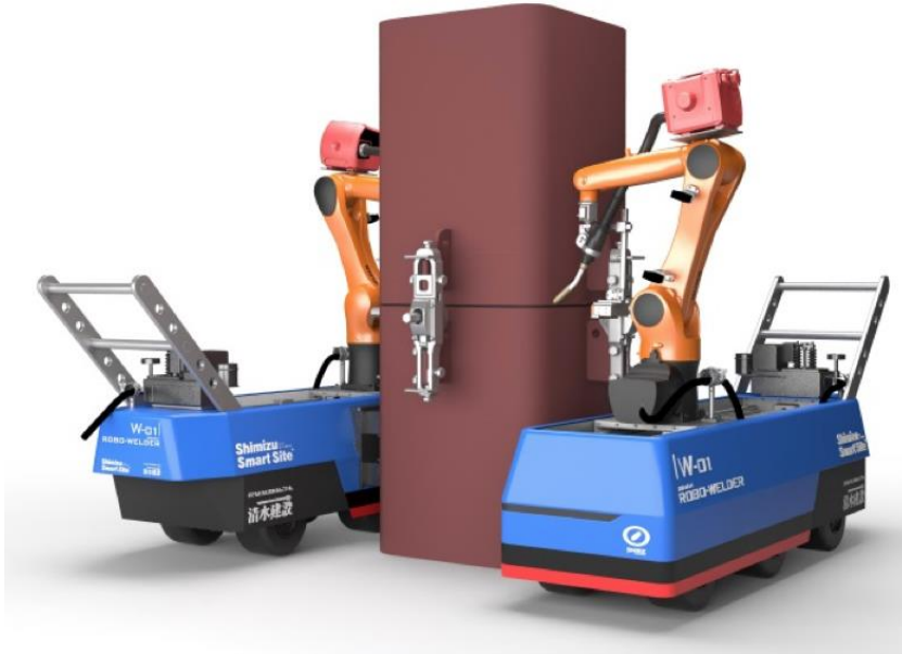
Kuva 6. Kaksi Robo-Welder-robottia hitsaamassa pilaria (Shimzu Corporation 2018).
