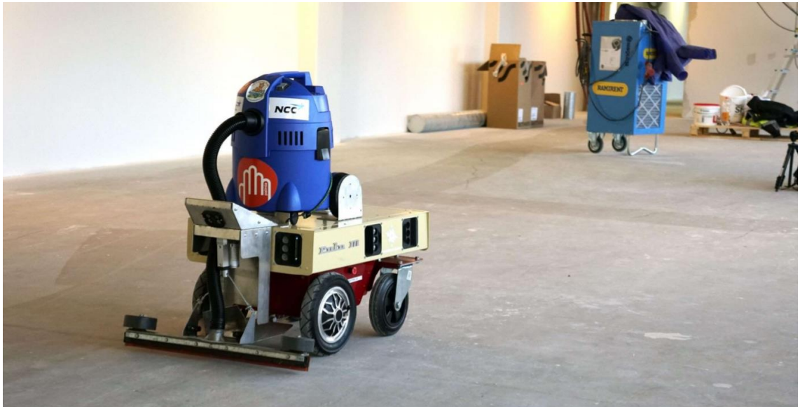
Kuva 4. Siivousrobotti työskentelemässä toimintaympäristössään (Heinonen 2019).
