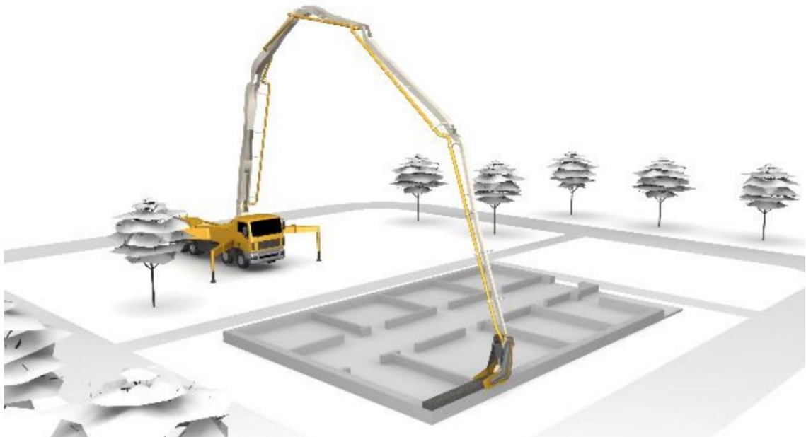
Kuva 9. Suorakulmaista rakennusta tulostettaessa tulostuslaite asetetaan talon ulkopuolelle (Krause ym. 2018).
