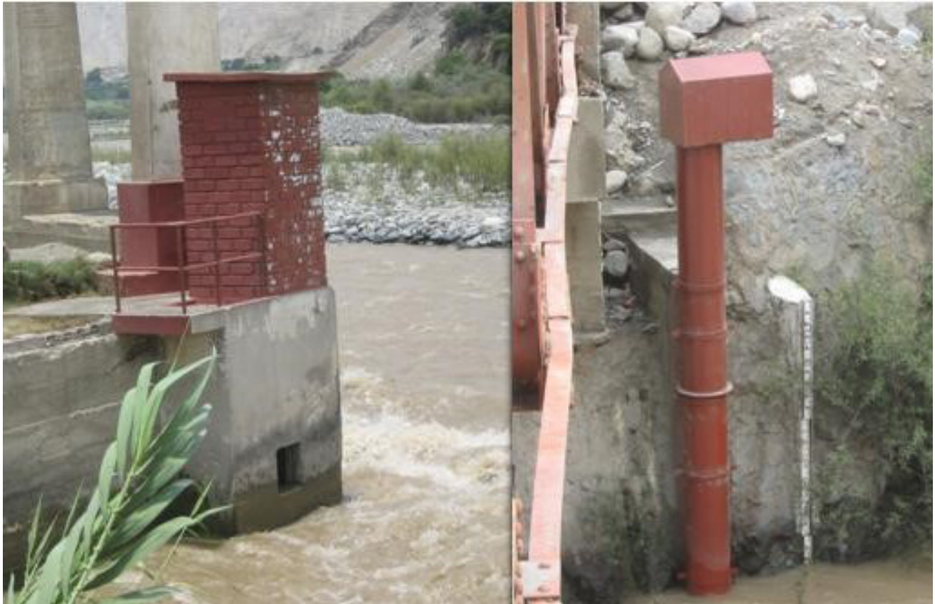
Casetas limnigráficas, de toma directa. A la Izquierda, Estación Socsi – río Cañete; a la derecha Estación Pacarán –río Cañete Fuente: SENAMHI
