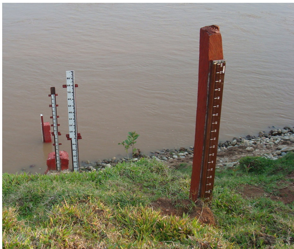
Reglas limnimétricas instaladas en cursos de agua Fuente: SENAMHI
