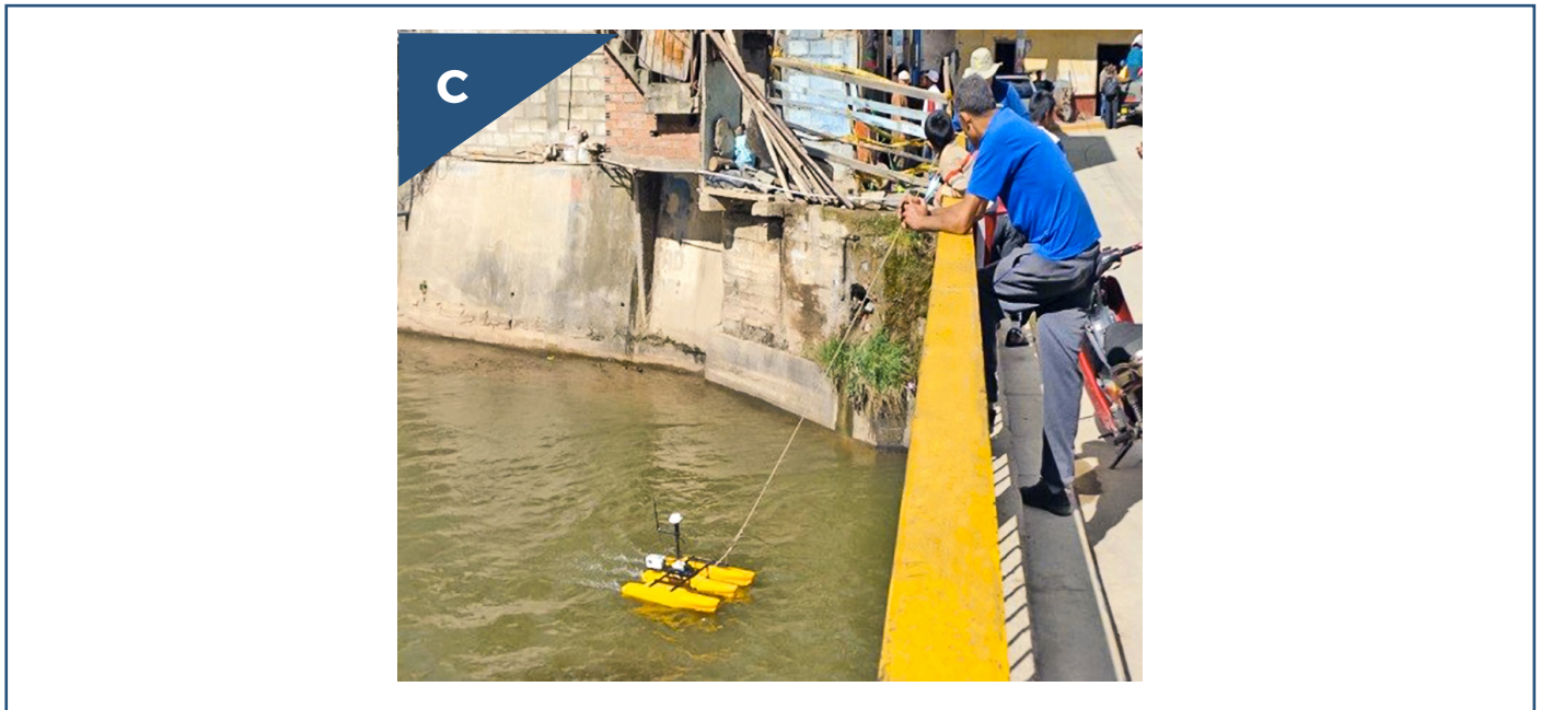
A) Aforo desde carro huaro con ADCP RiverRay. B) Aforo desde puente con ADCP M-9 C) Aforo con ADCP M-9 desde embarcación con motor fuera de borda Fuente: SENAMHI de Cajamarca, Huánuco y Piura
