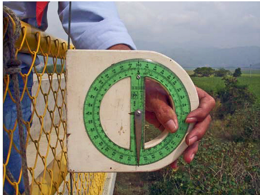
Transportador para medir ángulo de arrastre Fuente: Universidad del Valle
