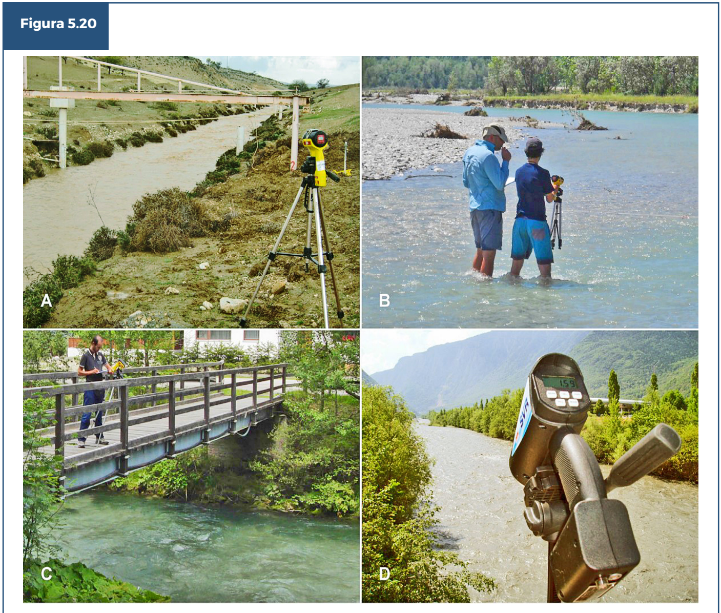
Vista de diferentes formas de utilizar la pistola radar en cursos naturales Fuente: Welber M. Le Coz, et al
