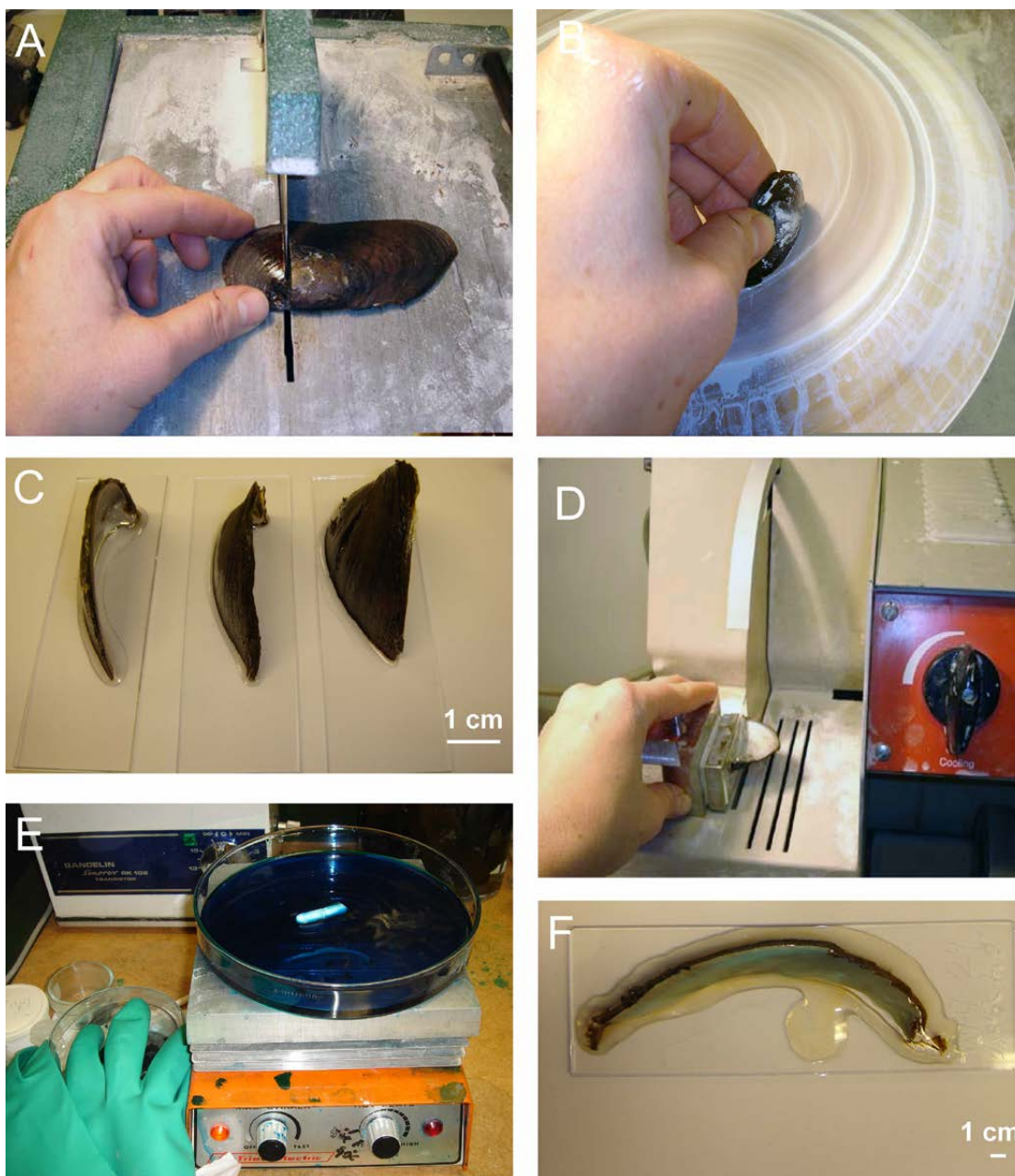
Figur 3.1. A. Skalen från flodpärlmusslorna sågades vinkelrätt mot vinterlinjerna från den ventrala kanten till umbo med hjälp av en diamantklinga; B. Polering av skalsnitten; C. Skalbitarna klistrades fast på objektglas; D. Skalen sågades så att ett tunt skalsnitt (ca 0,5 mm) blev kvar på objektglaset; E. Etsning med Mutvei's blandning; F. Färdigt slipsnitt.
