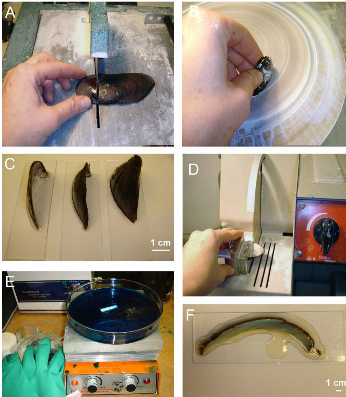
Figur 1.1. A. Musselskalen sågades vinkelrätt mot vinterlinjerna från den ventrala kanten till umbo med hjälp av en diamantklinga; B. Polering av skalsnitten; C. Skalbitarna klistrades fast på objektglas; D. Skalen sågades så att ett tunt skalsnitt (ca 0,5 mm) blev kvar på objektglaset; E. Etsning med Mutvei's blandning; F. Färdig slipsnitt.
