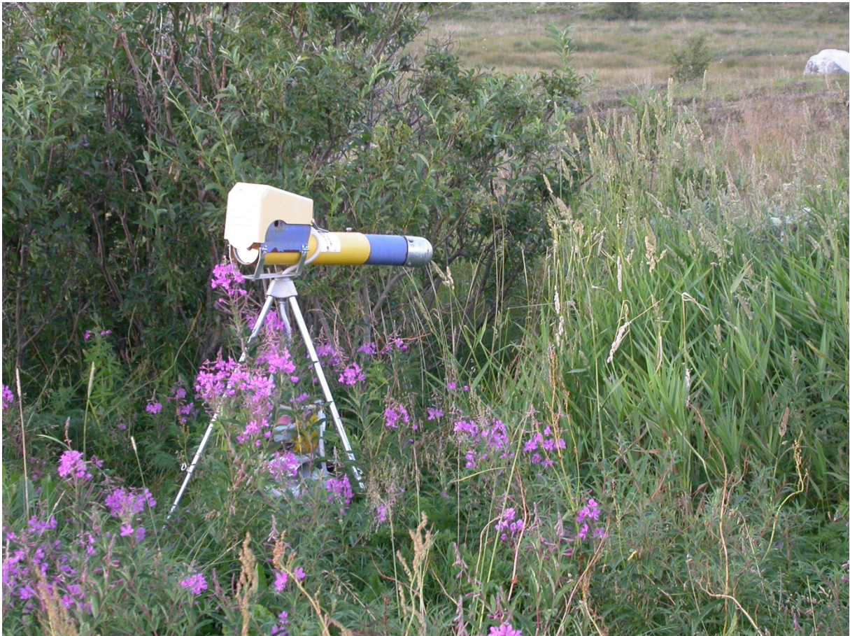
Figur 21. Gasskanon er brukt hyppig til å skremme vekk fugler fra områder de har vært uønsket, det være seg gjess fra beitemark eller fugler fra flyplasser. Foto: Arne Follestad.
