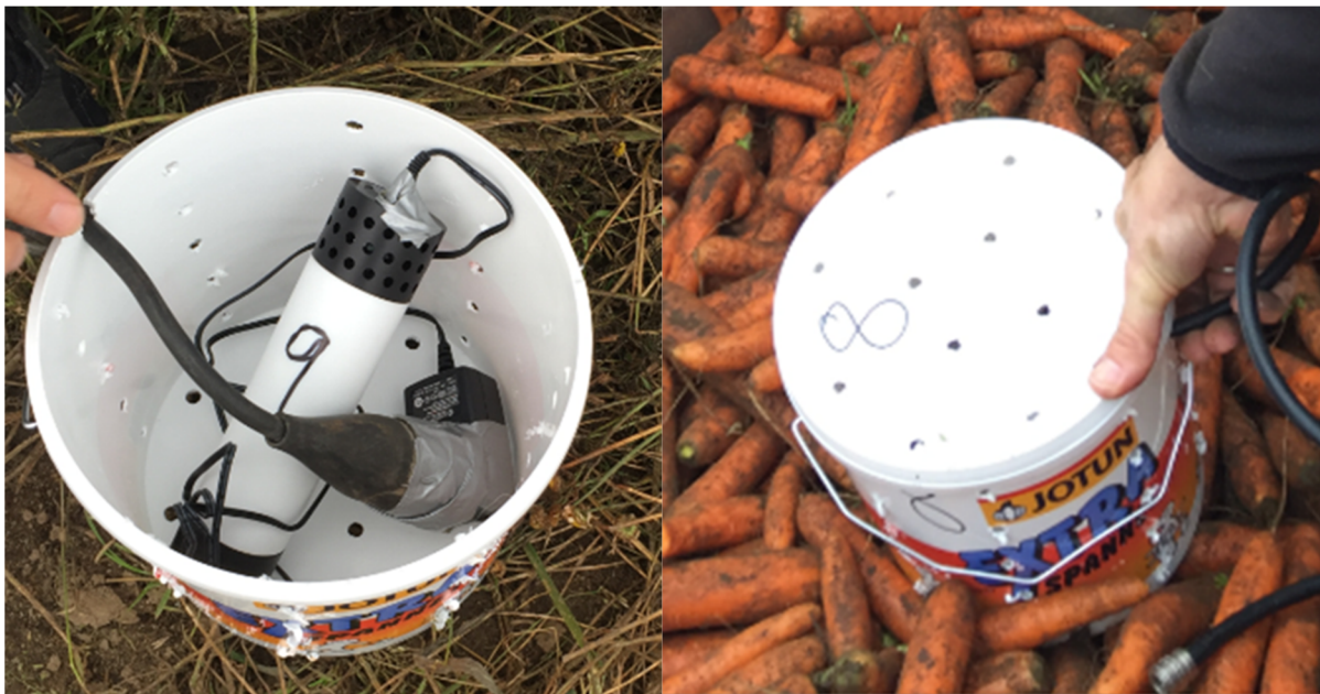
Bilde 5: CO 2 sensor fra 7Sense lagt i beskyttende plastbøtte plassert i midten av en gulrotkasse. Forsøksstart 27. september 2016. Foto: Pia Heltoft (NIBIO).
