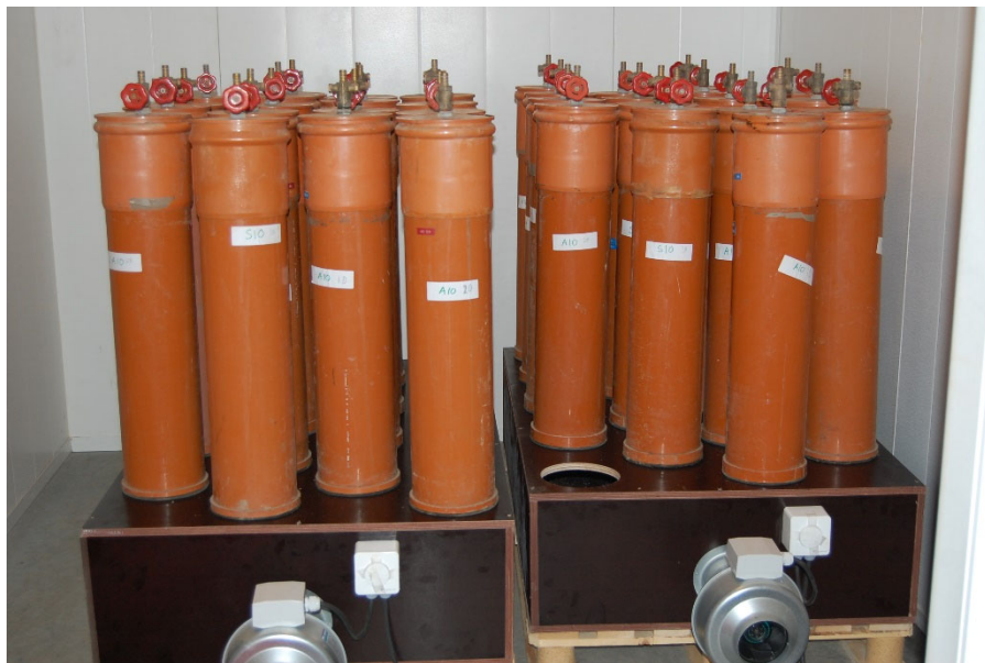
Bilde 2. Gulrot ble lagret i spesialbyggede ventilasjonskasser med vifte med regulerbar hastighet i bunn. Gulrøttene var lagret i «rør» med netting i bunn og åpning i topp med mulighet for regulering med kran. Hvert rør inneholder ca. 8 kg gulrot.
