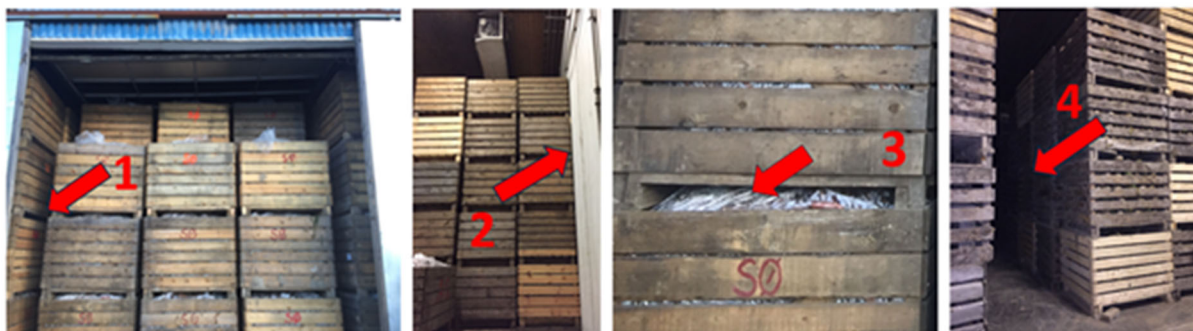
Figur 27. Bildene viser de mest sentrale faktorene som hindrer god luftsirkulasjon.
