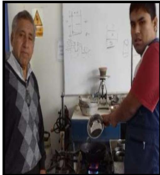
Foto 40; Se pone todo los materiales a la cocina para poder calentarse se coloca el martillo de compactación, briquetas y un sartén con el pen 60 y 70 calentándose a la cocina mientras los materiales están el horno de arena con cal y piedra; donde primero se ya a echar la mezcla asfáltica y se añade la cenizas de cascara de arroz para luego echar la piedra v arena respectivamente .
