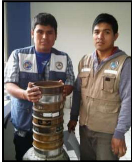
Foto 23; Se paso por las diferentes mallas el agregado fino donde se retienen por los diferentes tamiz donde después se pesan lo retenido en cada tamiz
