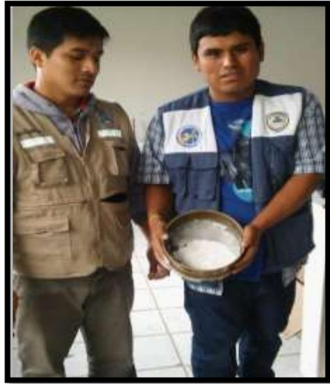
Foto 33; Se pasa la cal primero por la horganza para poder eliminar las partidas grandes y así después pasar por la malla N 200 para poder llevar al horno para combinarlo con la arena
