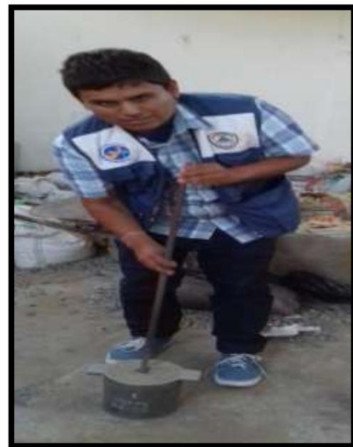
Foto 26; La muestra de agregado fino se cuartea y luego se pone el molde para agregarlo en el molde donde se tomara el peso unitario suelto y otro compactado tres cada uno
