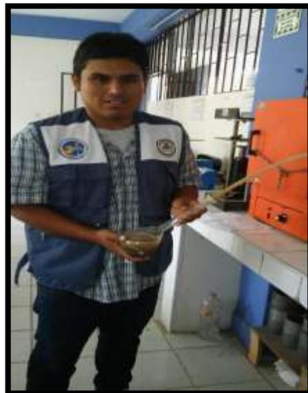
Foto 24; Se deja por 24 horas el agregado fino remojando y luego se seca en la cocina para luego pesar lo secado y luego se echa un poco de material al picnómetro
