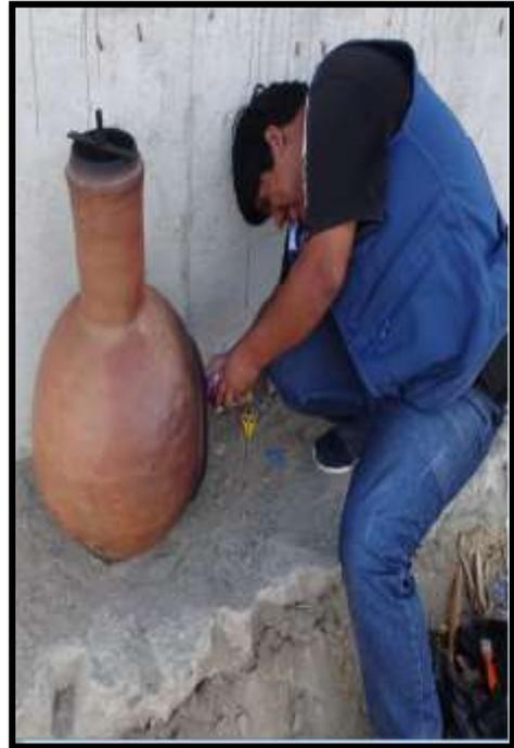
Foto 15; Se cocinó la cascara de arroz en una olla de barro en cielo abierto para hacerlo carbón
