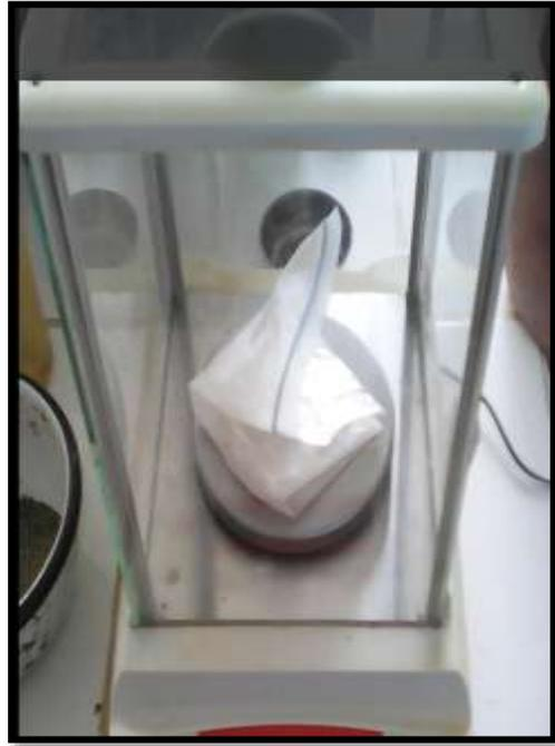
Foto 11; Luego se lleva a pesar a la balanza que solo necesitamos un 1 gramo del material de cascara de arroz para este ensayo
