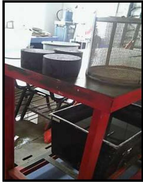
Foto 37; Se retira las briquetas y se pesa seco, sumergido y con agua
