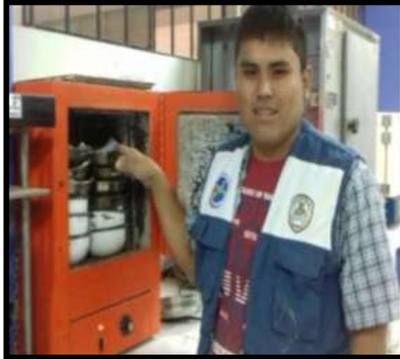
Foto 39; Se coloca todos los agregados piedra, arena y la cal al horno durante 24 horas para luego al día siguiente poder realizar el ensayo Marshall.
