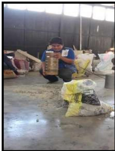
Foto 22; Se paso por las diferentes mallas el agregado grueso donde se retienen por los diferentes tamiz donde después se pesan lo retenido en cada tamiz
