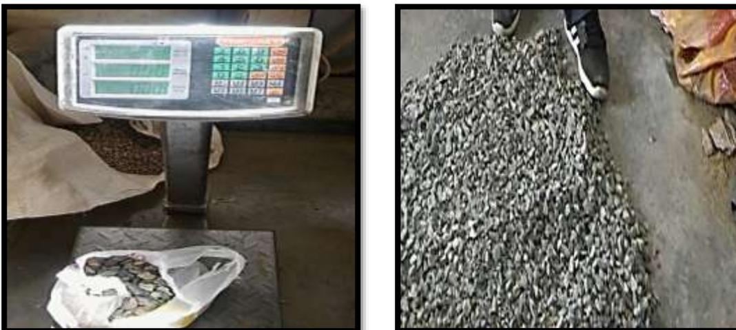
Foto 28; Se pesó 20 kg de agregado grueso para después pasarlo por la malla número 3/8", 1/2" y 3/4" donde el agregado pasante de cada uno de la malla se pesa.
