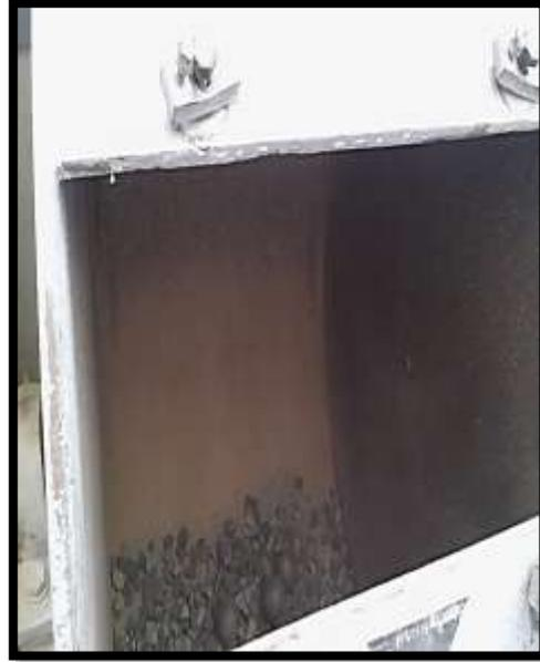
Foto 29; Se colocó en la máquina del ensayo de abrasión de los ángeles esferas de acero con un peso de 445 gr junto con el agregado grueso para luego esperar unos 15 minutos para retirar el agregado triturado donde se pesa en la balanza.
