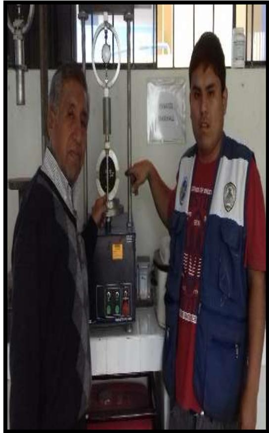
Foto 43; Luego se pone en el aparato Marshall donde obtenemos la deformación y el flujo
