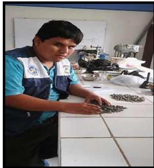
Foto 30; Se realizó el ensayo primero se pasó por la malla de  $\frac{1}{2}$  y lo retenido se separó al igual que el de  $\frac{3}{8}$  para luego pesarlo respectivamente
