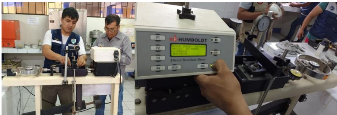
Foto n° 07 y 08 Instalación de Equipos para Ensayos de Corte directo y la Lectura del Resultado del Ensayo.
