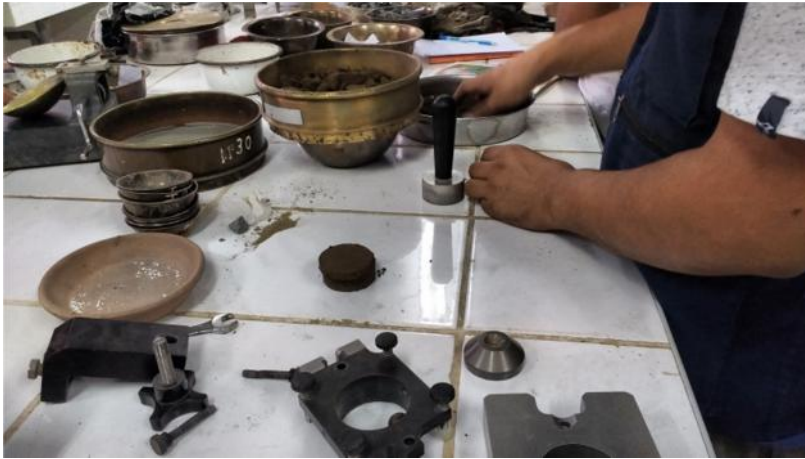
Foto n° 09 muestreo de materiales para Ensayo de Corte Directo de la Muestra 1, 2 y 3
