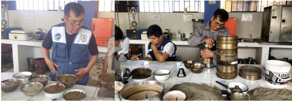
Foto n° 05 y 06 Trabajos de Pesado de Materiales y Tamizado para Ensayos de Granulometría
