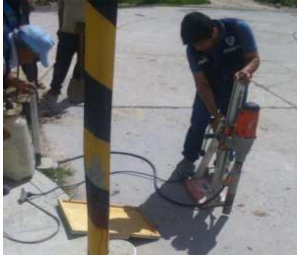
**Imagen. 01** extracción con perforadora diamantina M1, conjuntamente con el personal técnico responsable de Laboratorio de Mecánica de Suelos y ensayos de Materiales USP de Chimbote
