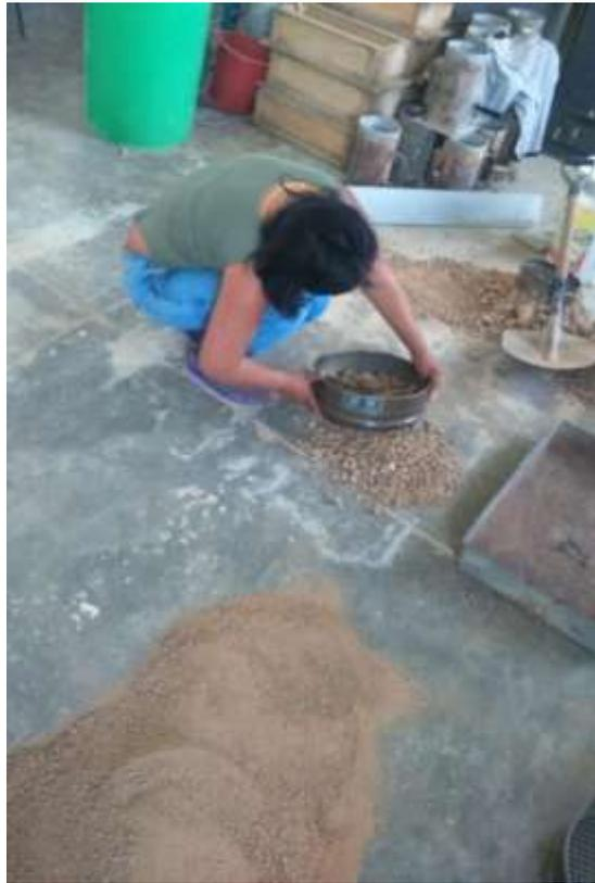
**Imagen. 09:** realizando el análisis granulométrico de la muestra en laboratorio USP
