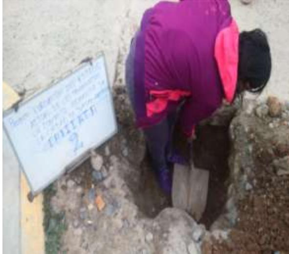
**Imagen. 04** se observa realizando la excavación para la extracción de la muestra de la calicata 02
