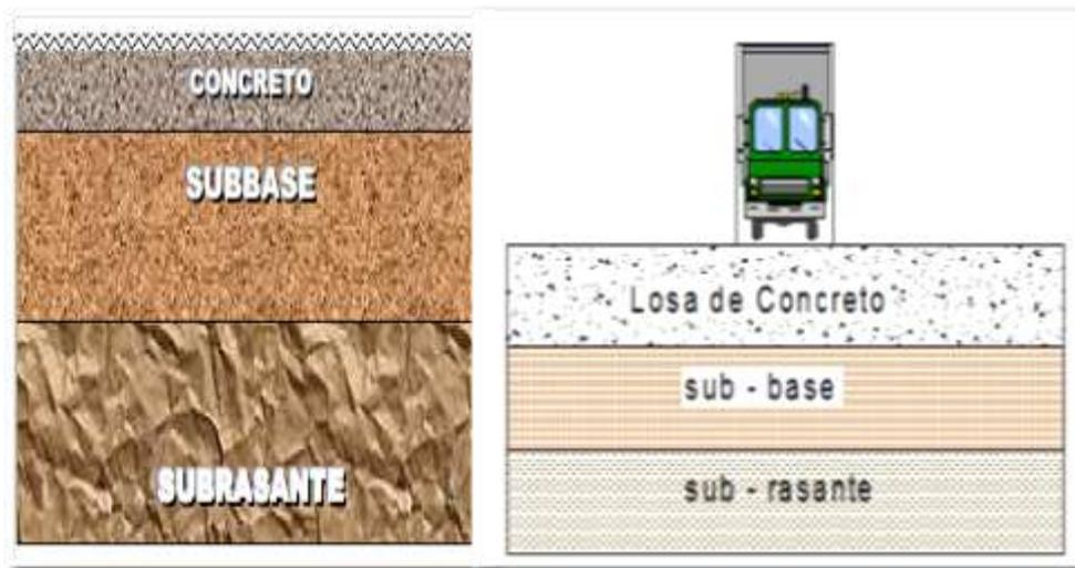
**Figura 1.** Esquema de los elementos que integran un Pavimento Rígido
