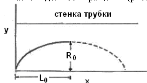
Рис. 1. Система координат для описания сил, действующих на каплю, вращающуюся вдоль оси x.
