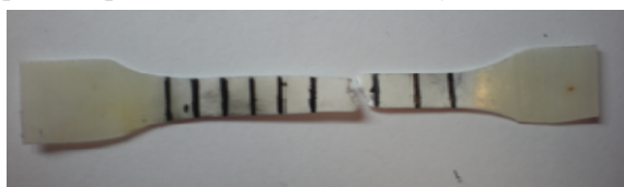
Рис. 2. Вид разрушенных образцов на основе невулканизированной (а) и вулканизированной (б) смеси состава 30 мас.% 1,2-ПБ – 70 мас.% ПЭ.
