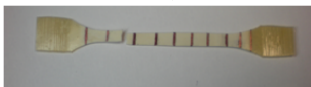
Рис. 2. Вид разрушенных образцов на основе невулканизированной (а) и вулканизированной (б) смеси состава 30 мас.% 1,2-ПБ – 70 мас.% ПЭ.
