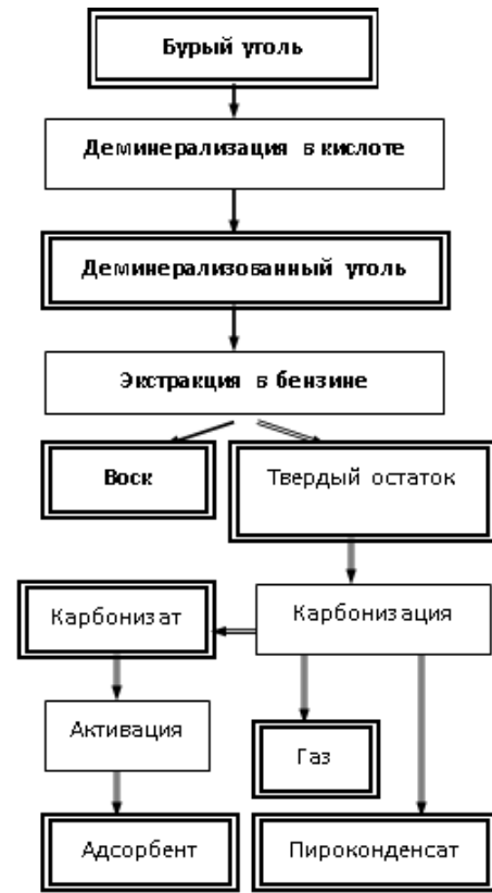
Рис. 1. Схема комплексной переработки бурых углей.
