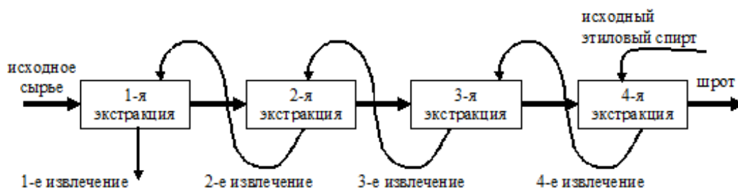
Рис. 1. Схема процесса «псевдонепрерывной» противоточной экстракции.
