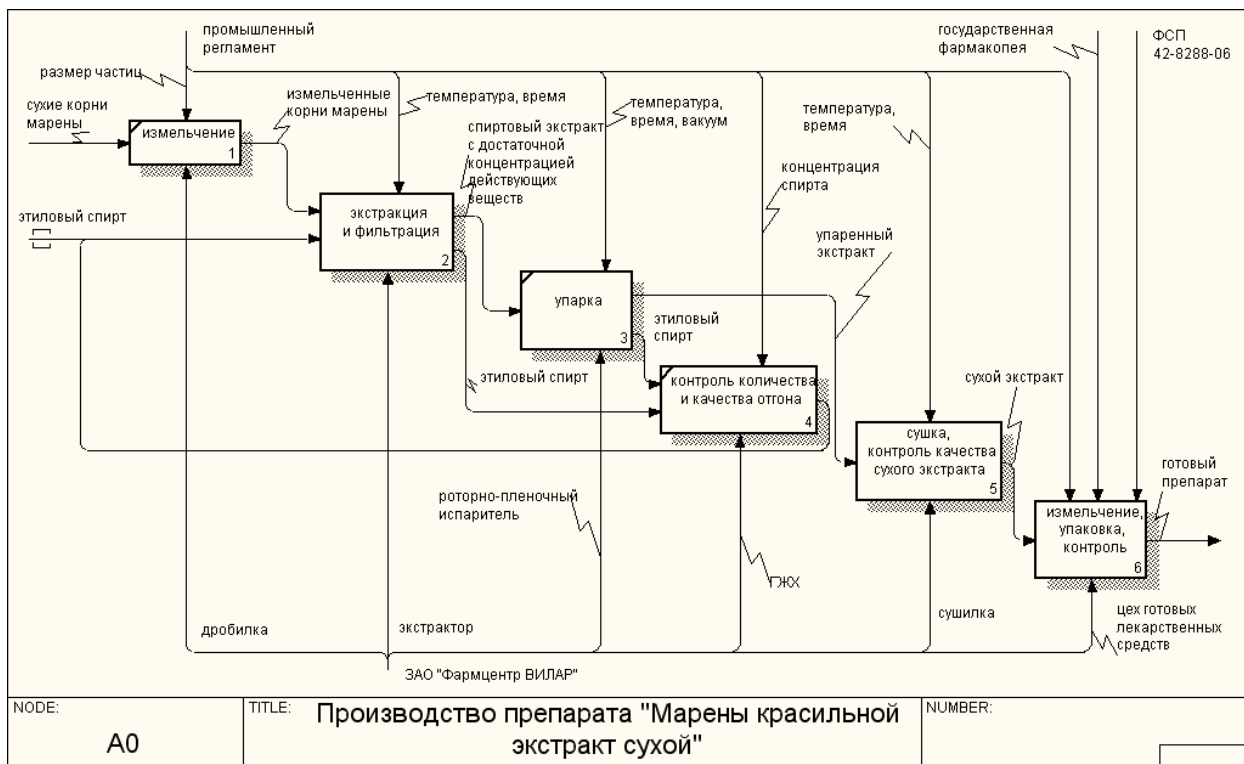
Рис. 2. Функциональная диаграмма, описывающая производство препарата «Марены красильной экстракт сухой».
