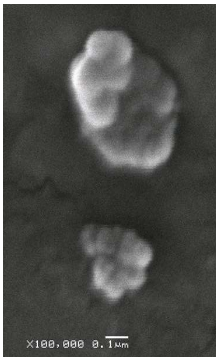
Рис. 2. Микрофотография резиновой частицы после перемешивания с горячим битумом.
