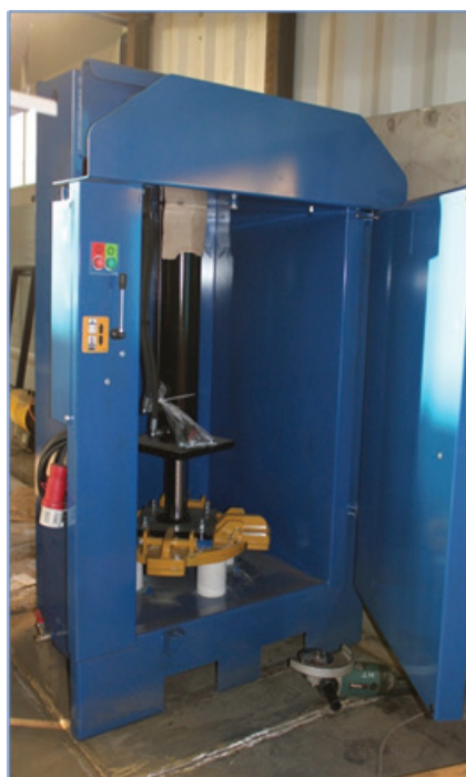
Рис. 2. Мобильный комплекс ФГУП «РосРАО» по сортировке, фрагментации и подпрессовке ТРО в бочках вместимостью 200 дм 3 .
