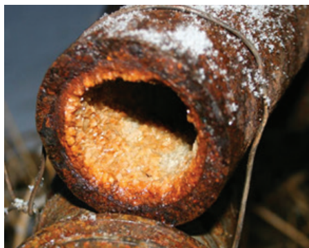
Рис. 6. Насосно-компрессорные трубы нефтедобычи, загрязненные внутренними отложениями Va(Sr, Ra)SO_4 с сосажденными из пластовых вод природными радионуклидами.
