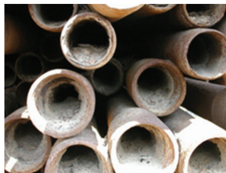
Рис. 6. Насосно-компрессорные трубы нефтедобычи, загрязненные внутренними отложениями Va(Sr, Ra)SO_4 с сосажденными из пластовых вод природными радионуклидами.
