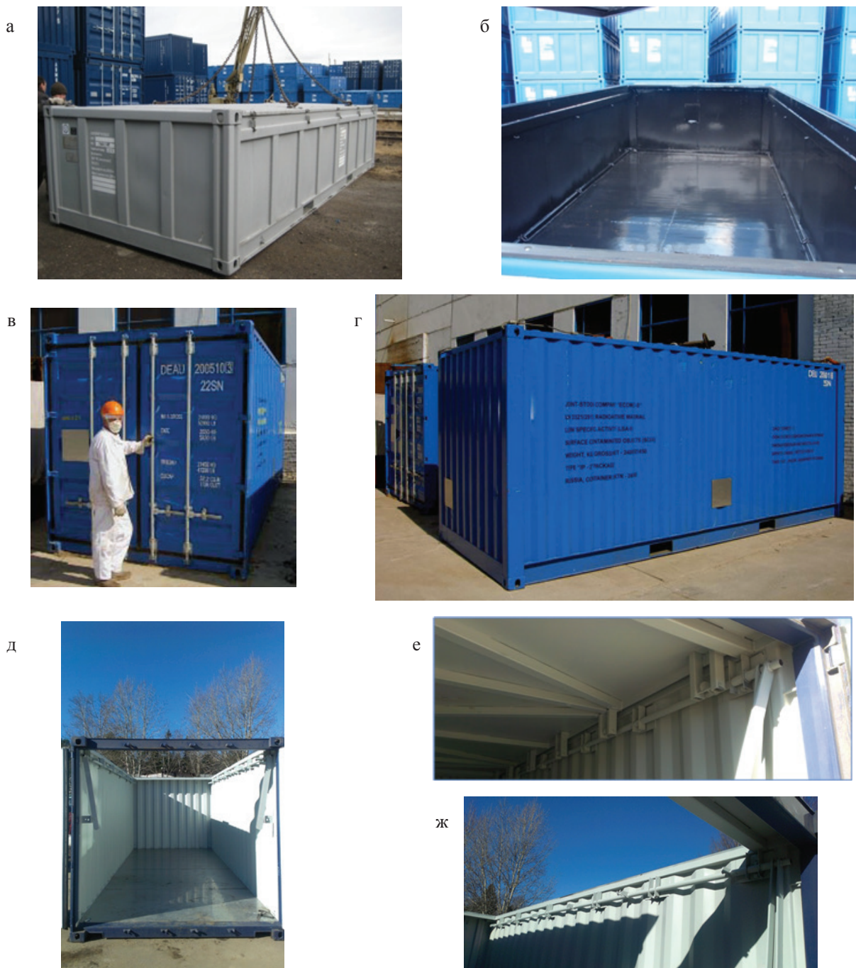
Рис. 1. Крупнотоннажные контейнеры для ТРО, используемые в ФГУП «РосРАО»: а, б – ПУ-2ЭЦ-СХ; в, г – ПУ-2ЭЦ-СС; д, е, ж – ПУ-2СТК-СК.
