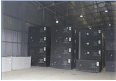
Рис. 3. Временное хранение контейнеризированных ТРО в легковозводимых хранилищах.
