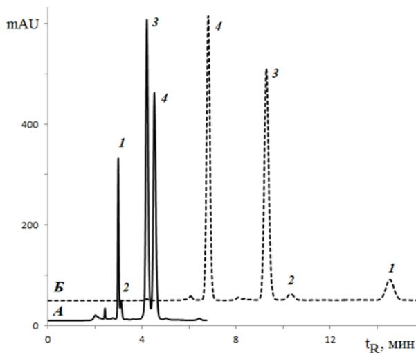
**Рис. 1.** Разделение антоцианов плодов бузины черной. Условия А: колонка: 4.6×250 мм Symmetry®C18, 5 мкм, в элюенте CH<sub>3</sub>CN–HCOOH–H<sub>2</sub>O (10:10:80 об. %). Условия Б: колонка: 4.6×250 мм Kromasil 60-5Diol, в элюенте CH<sub>3</sub>CN–H<sub>3</sub>PO<sub>4</sub>–H<sub>2</sub>O (80:0.5:19.5 об. %). Скорость подачи подвижной фазы 1 мл/мин; температура термостата колонки 40°C; детекция при 515 нм. Вещества: 1 – Cy3Sam5Glu; 2 – Cy3,5diGlu; 3 – Cy3Sam; 4 – Cy3Glu.
