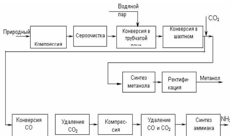
Рис. 2. Основные стадии совместных производств метанол-аммиак с параллельной структурой
