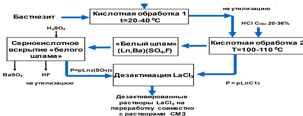
Рис. 6. Принципиальная технологическая схема переработки бастнезита в условиях ОАО «СМЗ».
