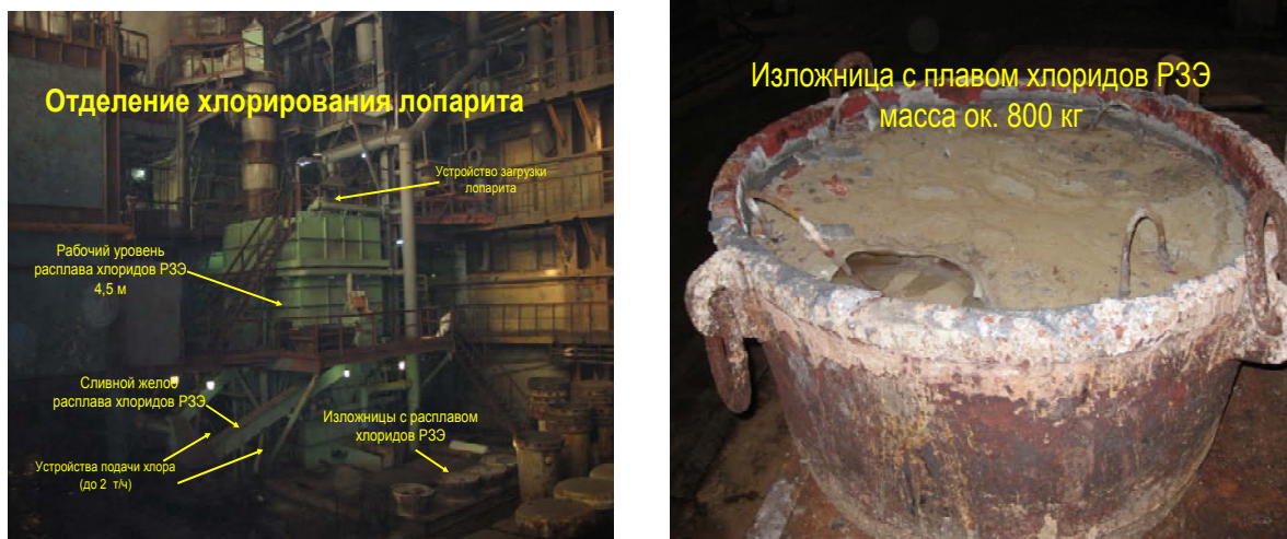
Рис. 4. Хлоратор для хлорирования лопаритового концентрата в солевом расплаве (слева) и изложница с плавом хлоридов РЗЭ (справа).
