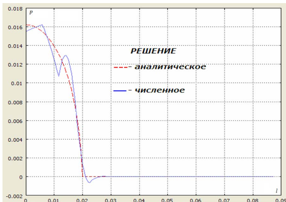
Рис. 3. Сравнение расчетов контактного давления.
