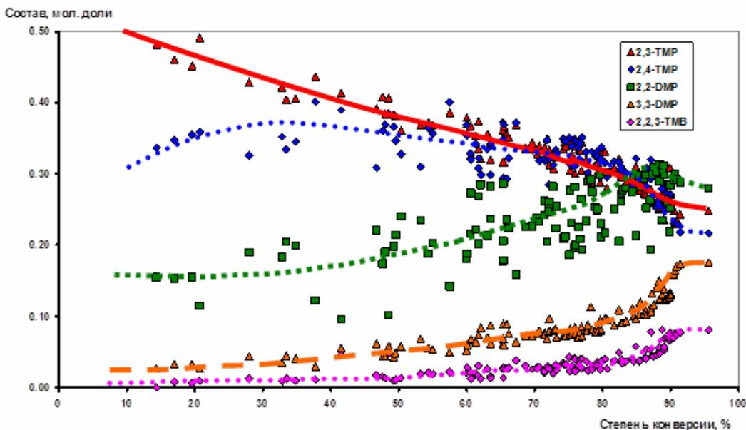
Рис.2. Зависимость состава разветвленных изомеров от степени конверсии *n*-гептана.
