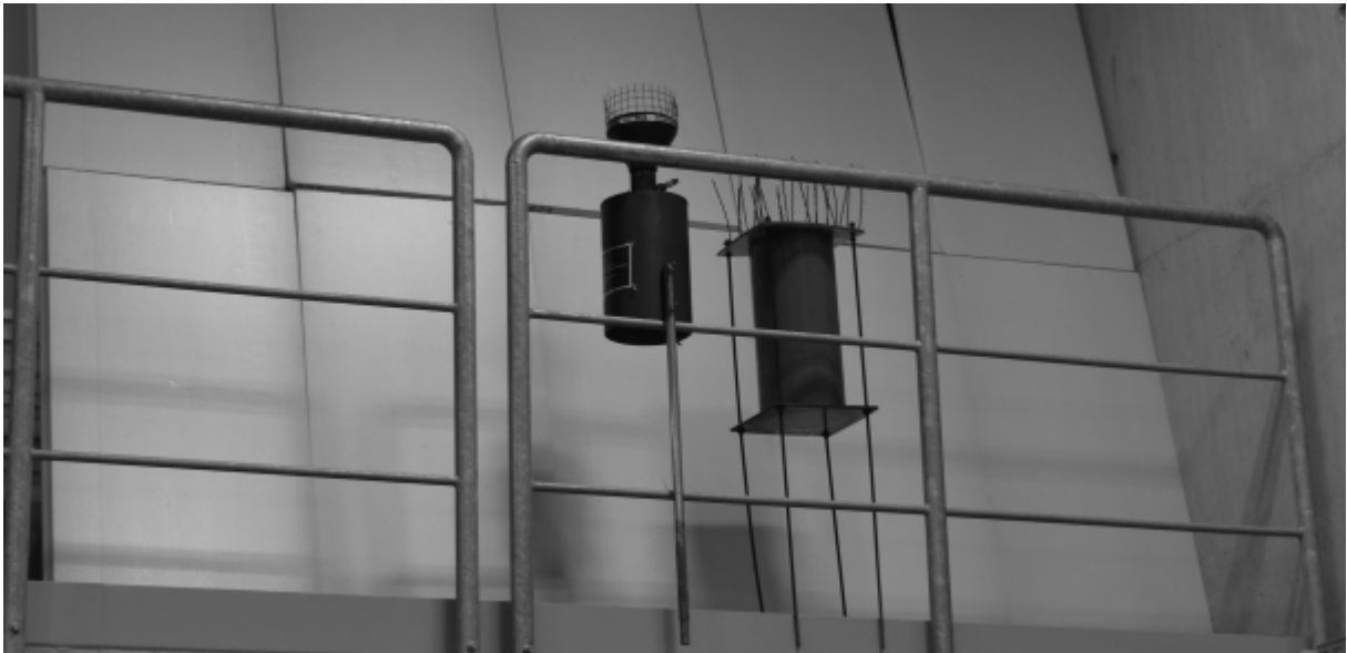
Abbildung 3.4: Anordnung des Silikonölsammlers (links) und des Wickelschlauchsammlers (rechts) am Ende der Galerie des Technikums.
