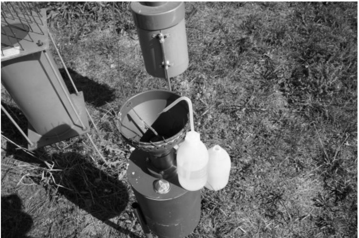
Abbildung A.5: Regelmäßige Reinigung des Wickelschlauchsammlers mit einem Pfeifenreiniger verhindert Algenwachstum im Sammler.
