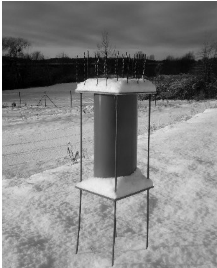
Abbildung A.2: Schneeschiicht auf dem Silikonölsammler am 21.01.2016 in Pirna.
