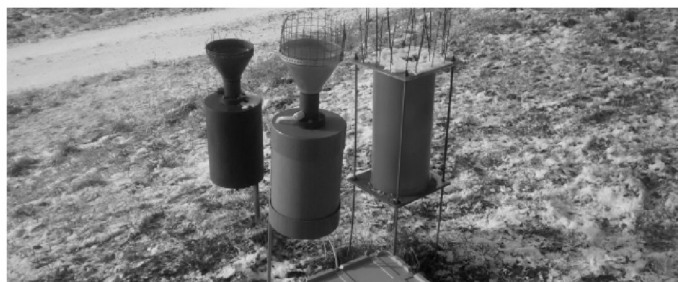
Abbildung 3.7: Drei Generationen isotopentreuer Niederschlagstotalisatoren an ihrem Einsatzort in Pirna. Rechts: Silikonölsammler; links: Wickelschlauchsammler nach Gröning et al. [2012]; Mitte: Heizsammler.
