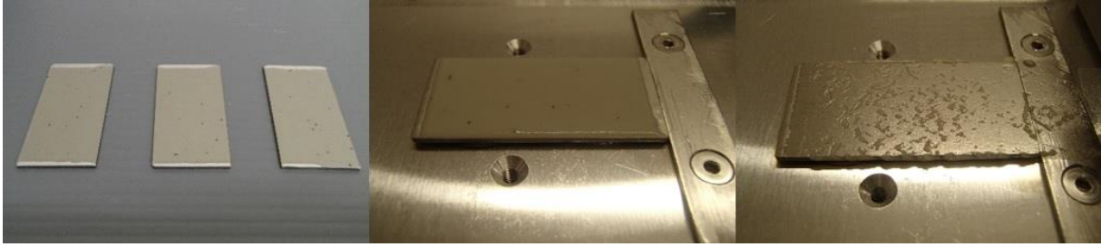
Abbildung 8-5: Versuchsdurchführung bei Vanillepuddingverschmutzung
