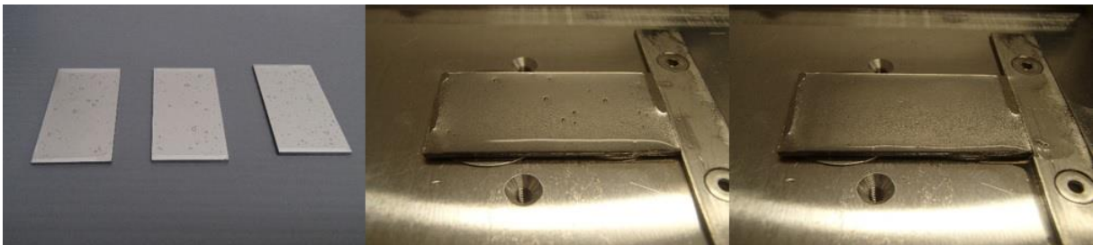
Abbildung 8-8: Versuchsdurchführung bei Stärkeverschmutzung
