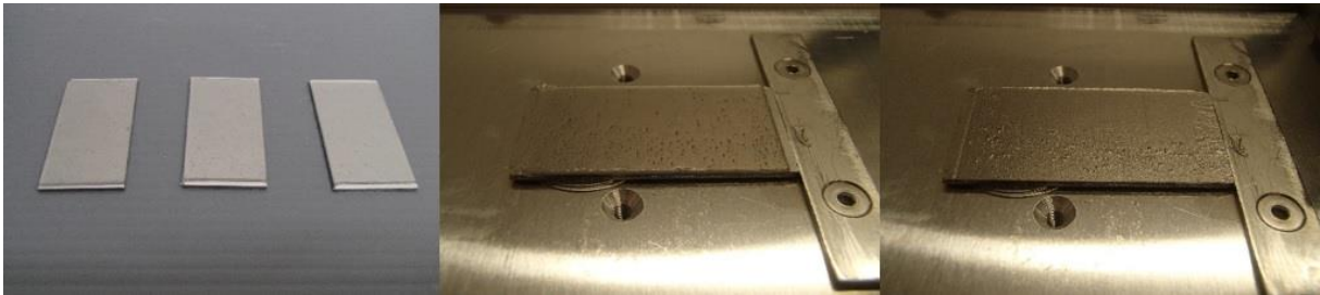
Abbildung 8-7: Versuchsdurchführung bei Vaselineverschmutzung
