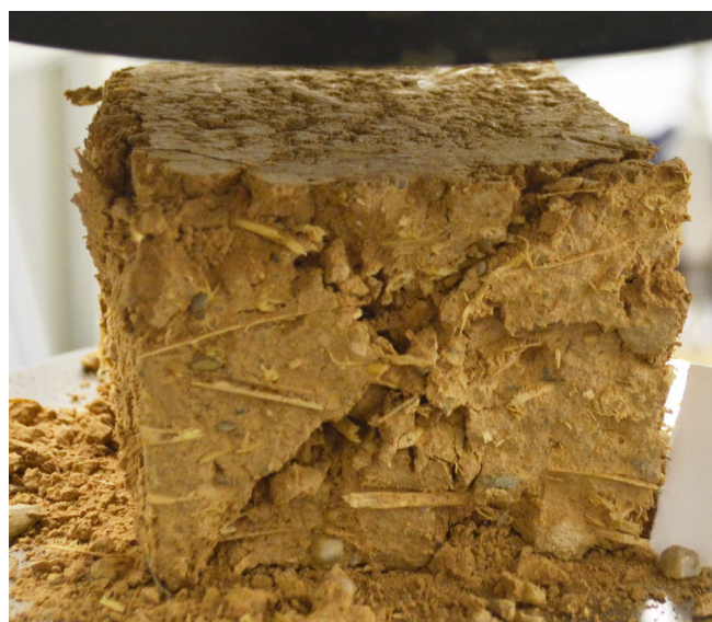
Figura 4. Modo de fallo en los especímenes cúbicos.
