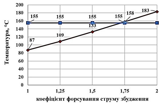
Рис. 7. Максимальна температура в пазу ротора неушкодженого ТГ в залежності від коефіцієнта форсування струму збудження
