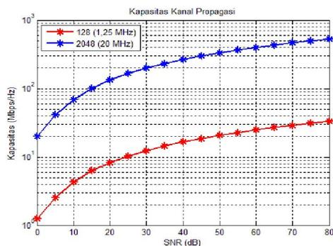
Gambar 5. Kapasitas Kanal Berdasarkan Jumlah *Subcarrier*
