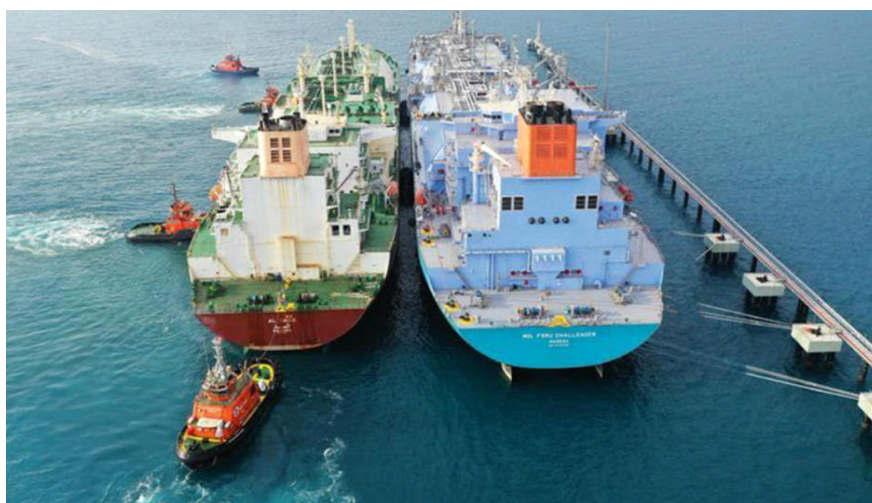
Gambar 1. Konfigurasi side-by-side pada transfer LNG (Sumber : http://mfame.guru/worlds-biggest-ship-to-ship-lng-transfers-starts-off-in-turkey/ ).
