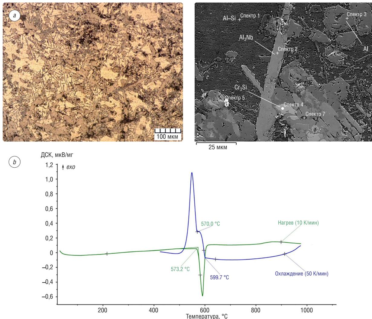
Рис. 2. Микроструктура (a), и кривые ДСК нагрева и охлаждения (b) сплава (68Al8Cr4Nb20Si) ат.%.
