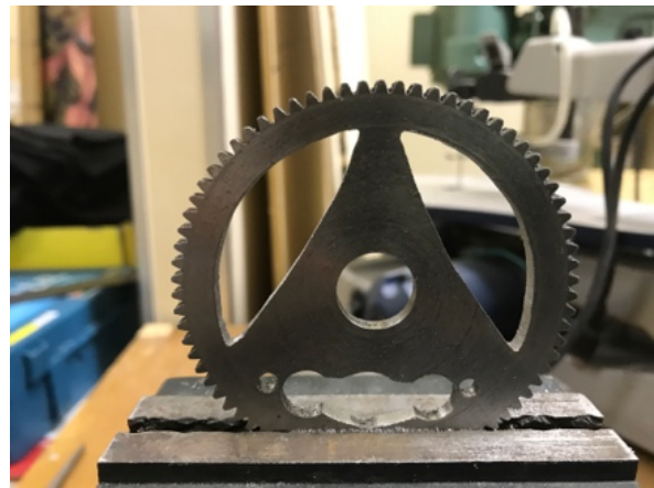
図16 ヤスリによる加工
