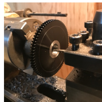
図 11 圧入穴の加工
