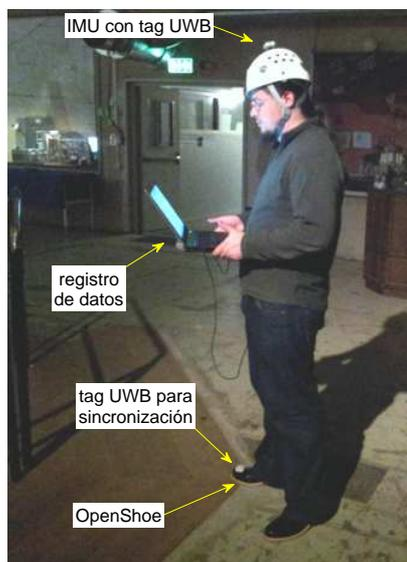
Figura 4.5: Equipo utilizado para la evaluación del sistema de fusión de PDR UWB/IMU utilizando un filtro de límites.
