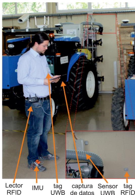
Figura 5.12: Dispositivos utilizados en el experimento. Se observa como uno de los sensores UWB no tiene línea de visión con el tag.
