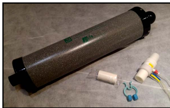
Fig. 14 Flujómetro, Jeringa de calibración, boquilla y pinzas. Fuente: Centro Médico Reebok, 2016.
